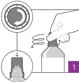
Kappe im Uhrzeigersinn bis zum Anschlag drehen, dadurch wird der Öffnungsbereich der Flasche durchstochen
