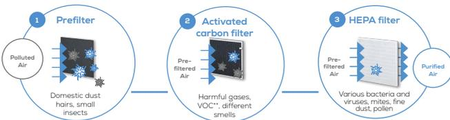
Funktionsweise des Luftreinigers: Hausstaub, Tierhaare, Gerüche, Pollen, schädliche Gase sowie diverse Bakterien und Viren werden mit Hilfe eines dreischichtigen Filtersystems aus der Luft gefiltert.
