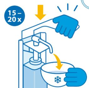
Anschließend die Pumpe 15 – 20 x betätigen und Reste in einem Auffangbehälter mit kaltem Wasser auffangen. Auf die produktspezifischen Einwirkzeiten ist zu achten.
