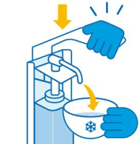
Bei diesem Vorgang Auffangbehälter unter die Auslassöffnung des Spenders halten. Die im Auffangbehälter aufgefangenen Reste können über das Abwassersystem entsorgt werden.
